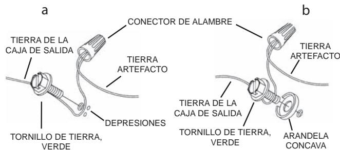
Haga las conexiones de los alambres. La tabla de referencia de abajo indica las conexiones correctas y los alambres correspondientes.
