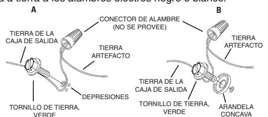
5) Haga les conexiones de los alambres (no se proveen los conectores.) La tabla de referencia de abajo indica las conexiones correctas y los alambres correspondientes.
