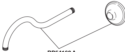
RP54168▲ Shower Arm & Flange Brazo de Regadera y Pestaña Tuyau de pomme de douche et collerette
