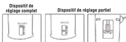
Dispositif de réglage complet de la chasse d'eau
